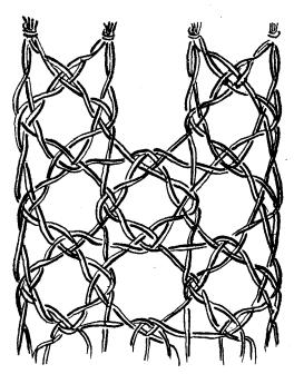
Fig. 163. — Démonstration du croisement des fils pour le point à la Vierge.
