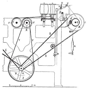
Fig. 23.—HAEMIG'S YARN-CLEANSING DEVICE
