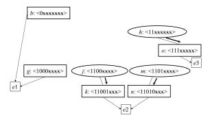
Fig. 5. Virtual Trie via BIS by Given Extents e1, e2 and e3
